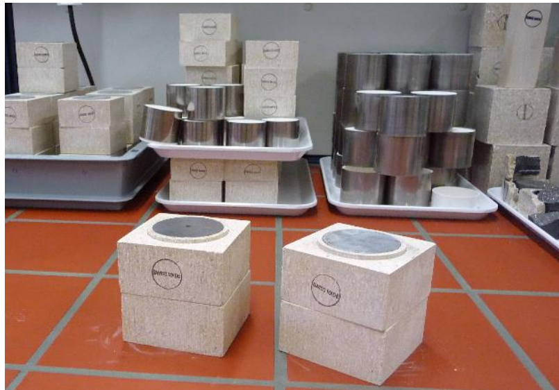
Wachstumzellen - aus Pyrophyllit mit Graphit, Katalysatoren, sowie Impfdiamant bestückt
