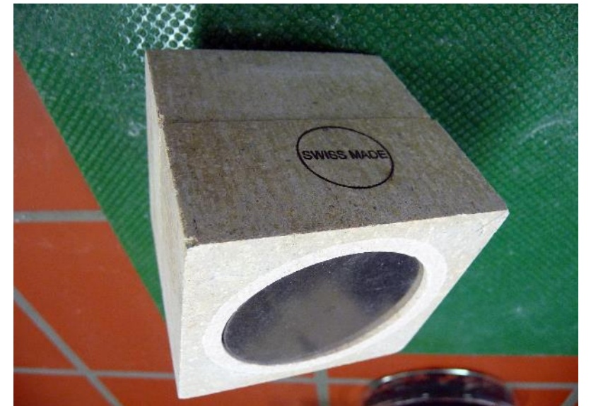
Wachstumzellen - aus Pyrophyllit mit Graphit, Katalysatoren, sowie Impfdiamant bestückt
