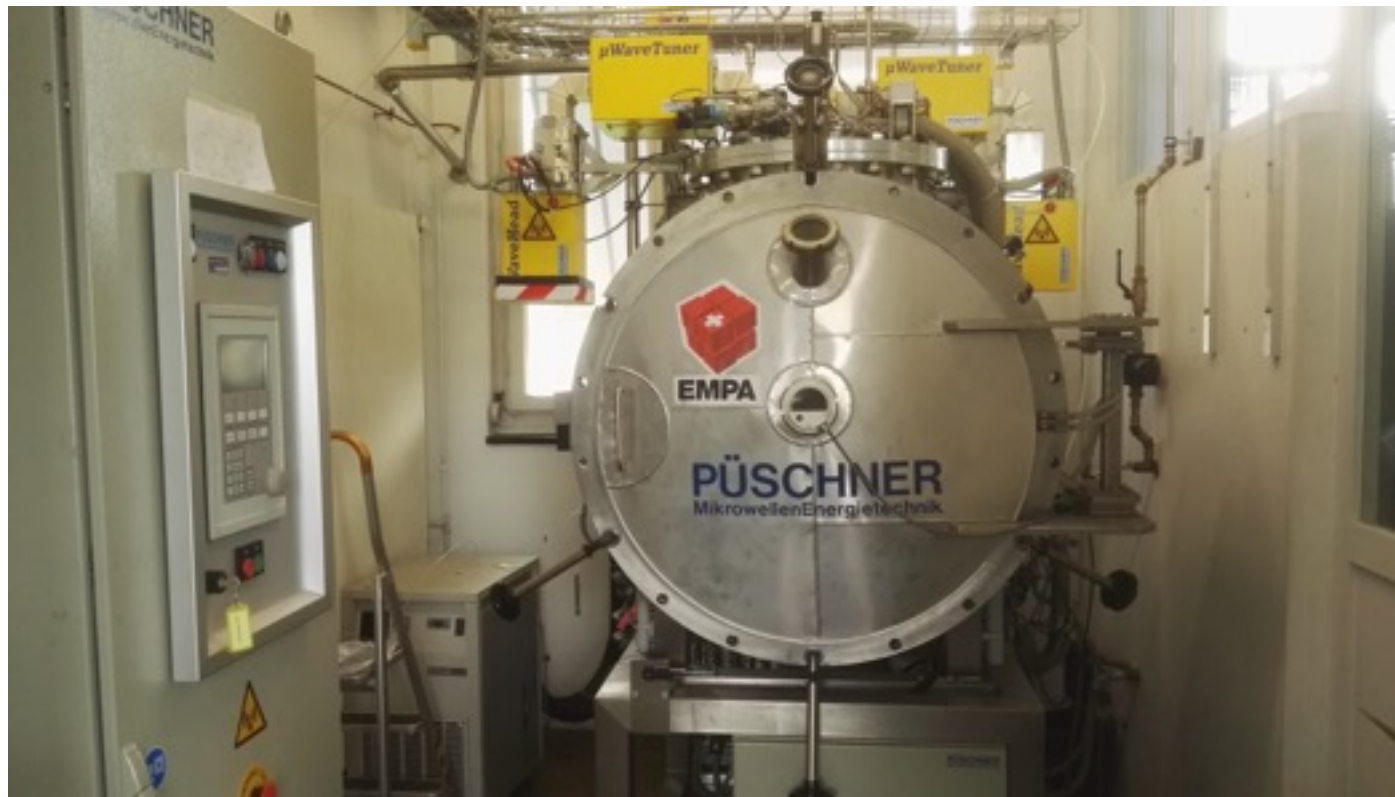
Mikrowelle zum Erhitzen nach der Bestrahlung in sauerstofffreier Umgebung zwischen 700 – 900 Grad, Mikrowellenleistung 15 kW / 2450 MHz
